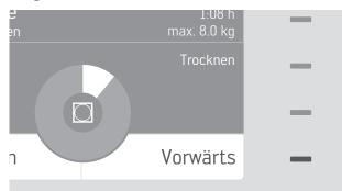
▶ Drücken Sie so lang auf den Leuchtbalken bei **Vorwärts**, bis der gewünschte Programmschritt angezeigt wird.
