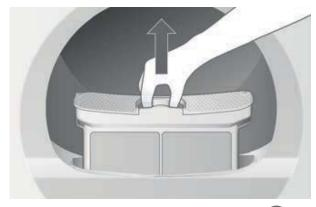
► Entnehmen Sie den inneren Filter A und klappen Sie ihn auf.
