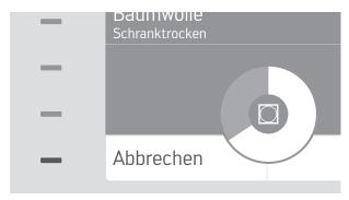
Drücken Sie so lang auf den Leuchtbalken bei **Abbrechen**, bis **Ende** angezeigt wird.
